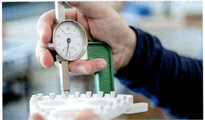
Abb. 3: Während der Herstellung sollte die Höhe des entsprechenden Besatzmaterials regelmäßig kontrolliert werden. alle Abb.: Filip GmbH Müllereibürsten
