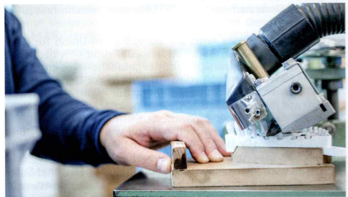
Abb. 4: Das Besatzmaterial muss langsam und gleichmäßig beschnitten werden – exakt auf den Abstand zwischen Sieb- bzw. Wellgitterboden und Siebgewebe.
