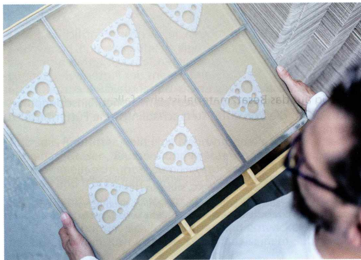
Abb. 1: Noppensiebreiniger von Filip in einem Novapur-Siebkasten
