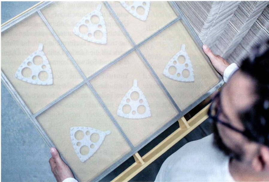
Abb. 3: Doppel-Reiniger mit Noppen für Vorsiebe in einem Novapur-Siebrahmen
